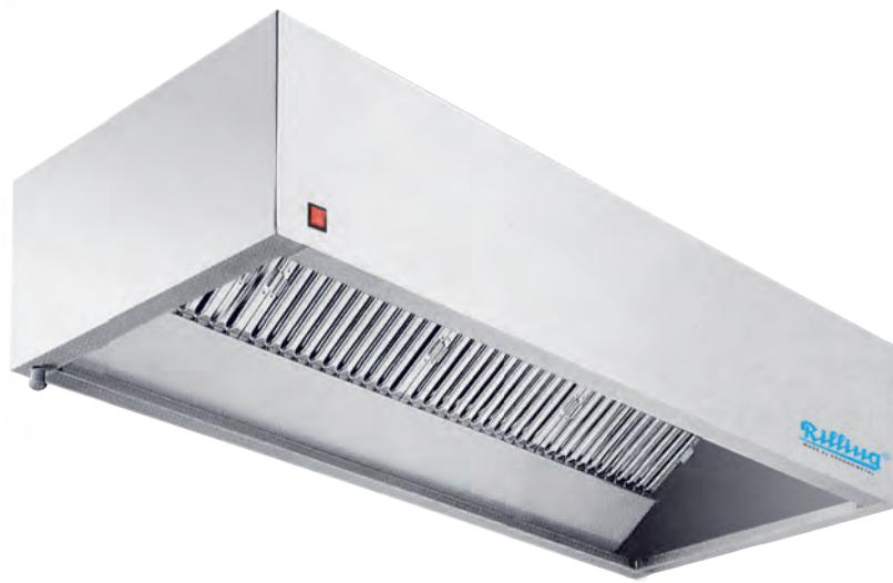
Ze stali nierdzewnej, z oświetleniem LED z łatwo wymienialną świetlówką oraz rynienką ociekową z zaworem spustowym, z filtrami labiryntowymi ogniodpornymi typu A 400x500x40 mm ze stali nierdzewnej.
