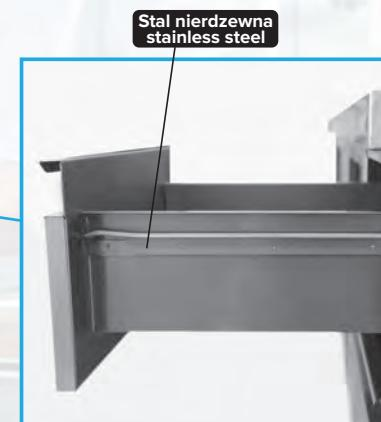
Korpus szuflady to całościowa skrzynia z prowadnicą nierdzewną, przystosowana do pojemników GN. Nośność szuflady 40 kg. Szuflady są zabezpieczone przed wysunięciem, jednak można je wyjąć do czyszczenia.
