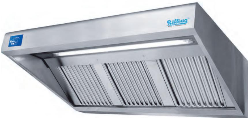
Ze stali nierdzewnej, z wentylatorem, sterownikiem cyfrowym, oświetleniem LED z łatwo wymienialną świetlówką oraz rynienką ociekową na kondensat i zaworem spustowym; z filtrami labiryntowymi ogniodpornymi typu A 400x500x40 mm ze stali nierdzewnej.
