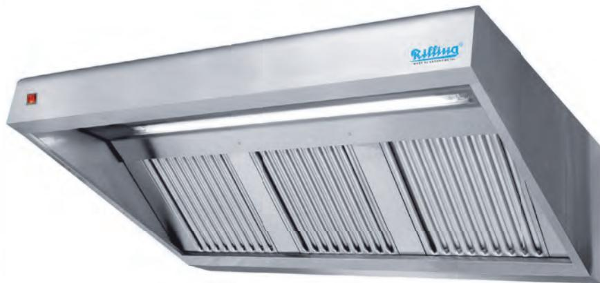
Ze stali nierdzewnej, z oświetleniem LED z łatwo wymienialną świetlówką oraz rynienką ociekową na kondensat i zaworem spustowym; z filtrami labiryntowymi ogniodpornymi typu A 400x500x40 mm ze stali nierdzewnej.
